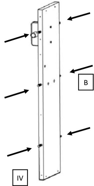
Stange einstecken und 3 Unterlegscheiben aufstecken
